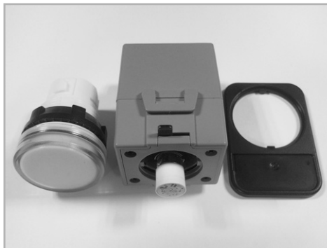
(1) 트랜스부 레바를 밀어 홀다부 분리한다 (Disassemble the holder part to push lever of trans part)
