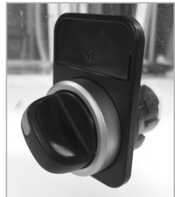
(3) 체결링을 우측으로 돌려 조인다 (Turn it to the right side to joint)
