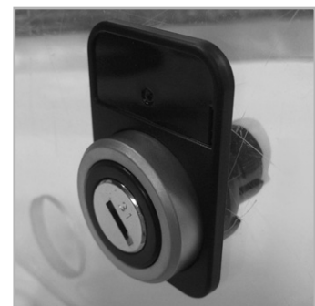
(3) 체결링을 우측으로 돌려 조인다 (Turn it to the right side to joint)
